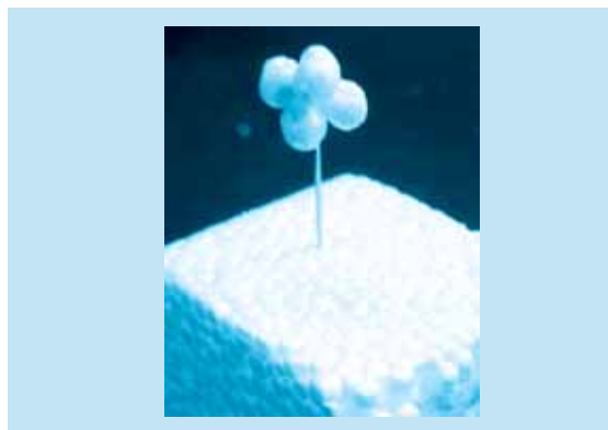
شکل ۲ تشکیل هسته اولیه برای تهیه توپ، با چسباندن دانه‌های جدا شده پلی‌استیرین
