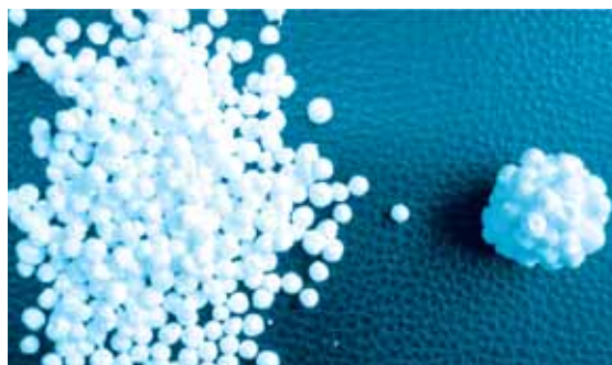
شکل ۳ تهیه توپ با چسباندن دانه‌های پلی‌استیرین به یکدیگر
